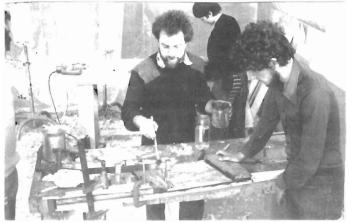
L'intérieur du puits est plastifié avant assemblage
