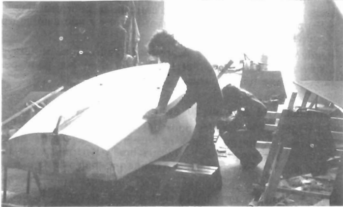
Enduit et ponçage sont les secrets d'une belle carène
