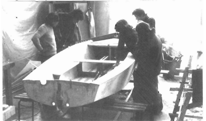
Les caissons sont terminés, plastifiés et enduits, les bancs posés... il n'y a plus qu'à peindre !
