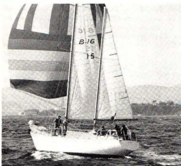
Grâce à un grand mât relativement court, le Beaufort 16 porte un spi très large et facile à tenir. (Photos La Nouë-Bateaux.)
