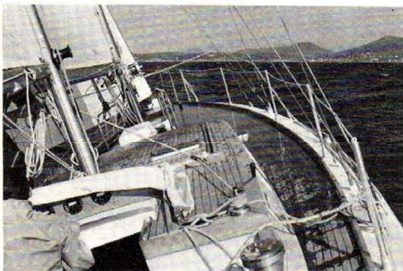
Les embruns qui mouillent le pont n'atteignent pas l'arrière du roof qui abrite l'équipage.
