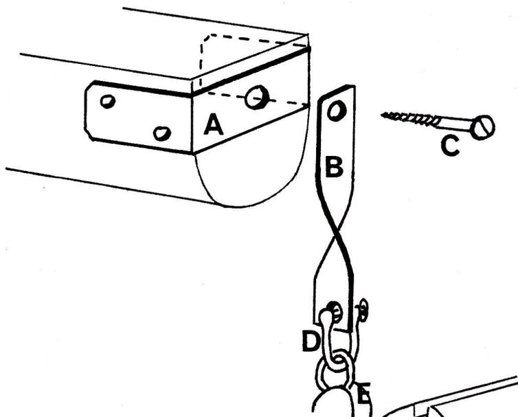
Fixer la ferrure (A) par 4 vis à bois inox tête fraisée de  $4 \times 15$ .
